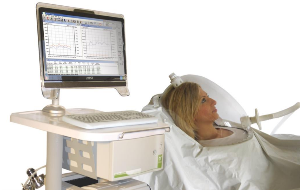
Figur 3: Kommersiellt instrument för indirekt kalorimetri med "huva". Frisk luft tillförs via slangen som är kopplad till ventilen på nedre delen av huvan. Luft leds också ut från huvan för mätning av koncentration av syre och koldioxid. Resultaten kan följas över tid på monitorn till vänster i bild.
